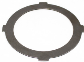
صفحه فلزی گیربکس Disc Forward Clutch Outer P.N: 2601011020
